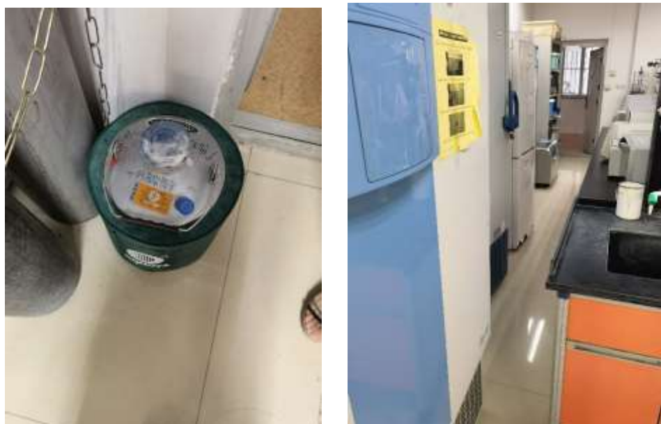
(12) 613 液氮罐未挂状态牌、通道被堵。
